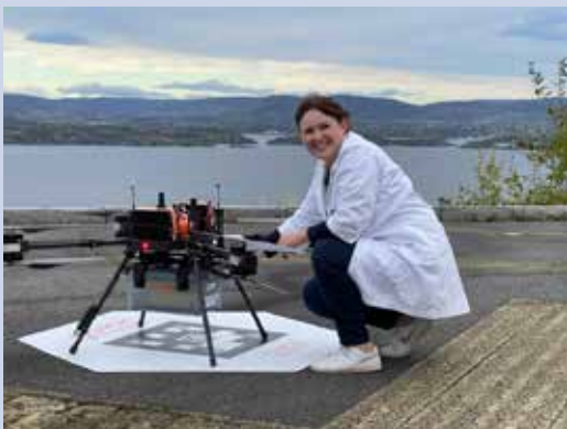
Firemotors drone med transportkasse festet under
